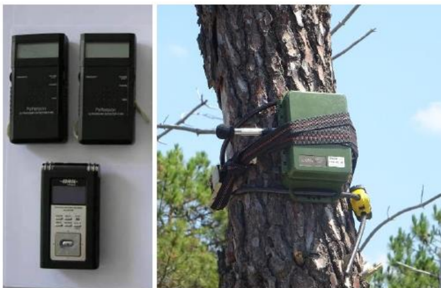
Détecteurs d'ultrasons Pettersson et enregistreur numérique à gauche et SM4 posé in situ à droite
